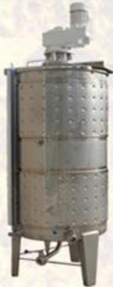
Depósito de doble camisa con agitador superior extraíble.
